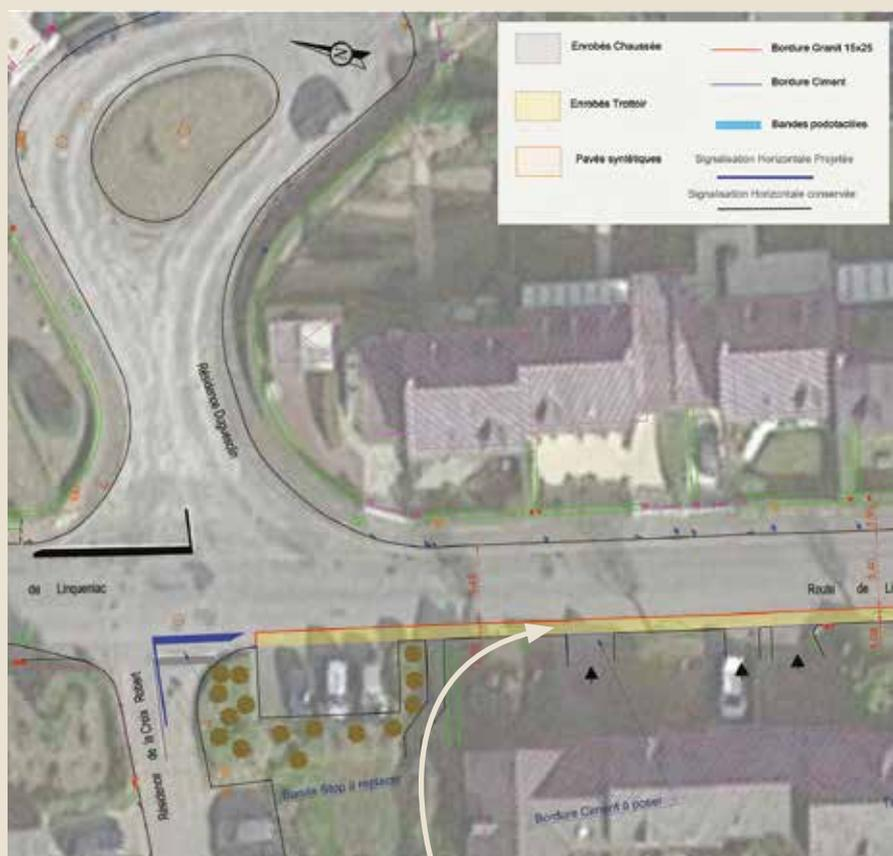
*En partie basse, le projet prévoit la création d'un trottoir d'un mètre de large sur la partie ouest. La route passera ainsi d'une largeur de 6.50 m à 5.5 m.*
